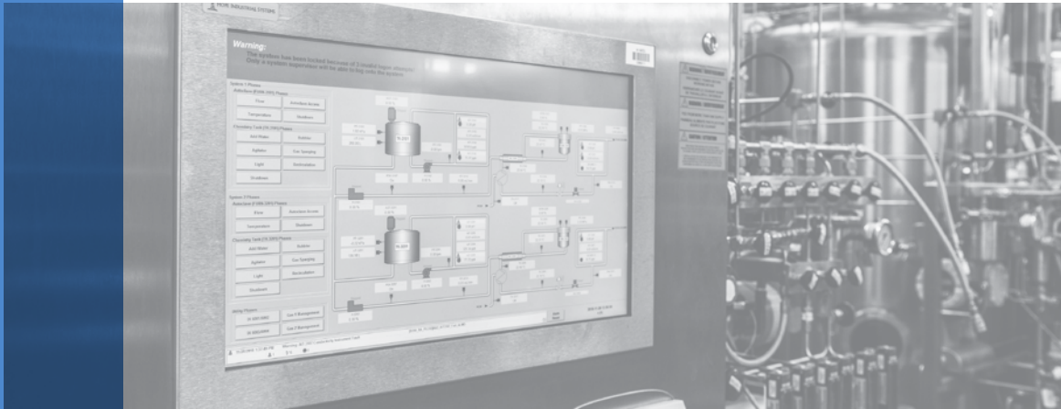
Panneau de commande pour les systèmes d'autoclave nouvellement reconstitués des LNC, utilisé pour étudier la performance des matériaux à des températures et pressions élevées tout en permettant de surveiller et de contrôler les conditions chimiques de l'eau dans les autoclaves.
