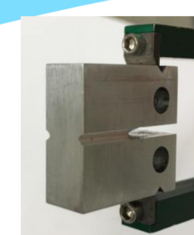
Spécimen compact à rainure latérale (CT) - Essai de dureté
