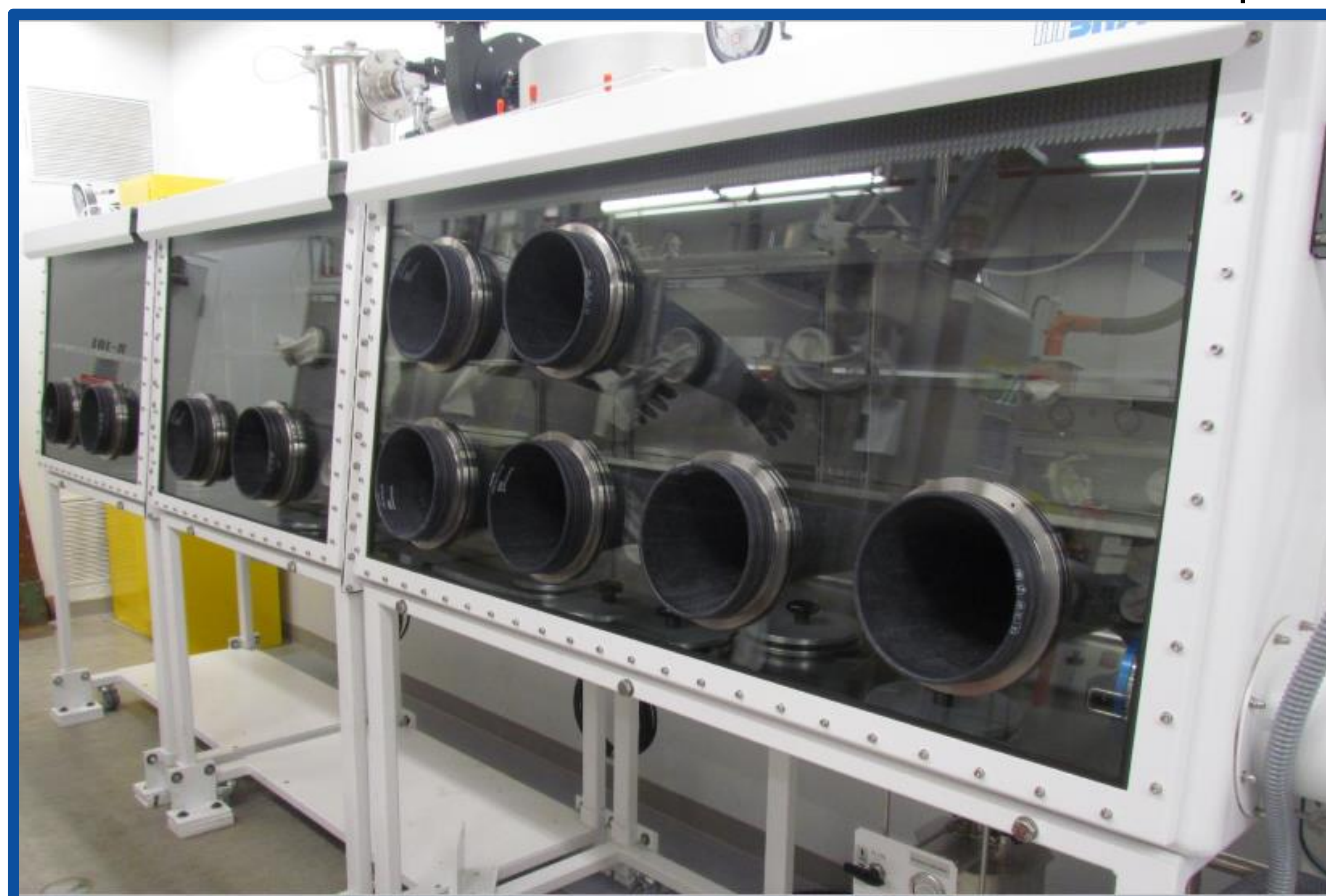
Figure : Boîte à gants à atmosphère inerte pour la synthèse de combustible à sel fondu
