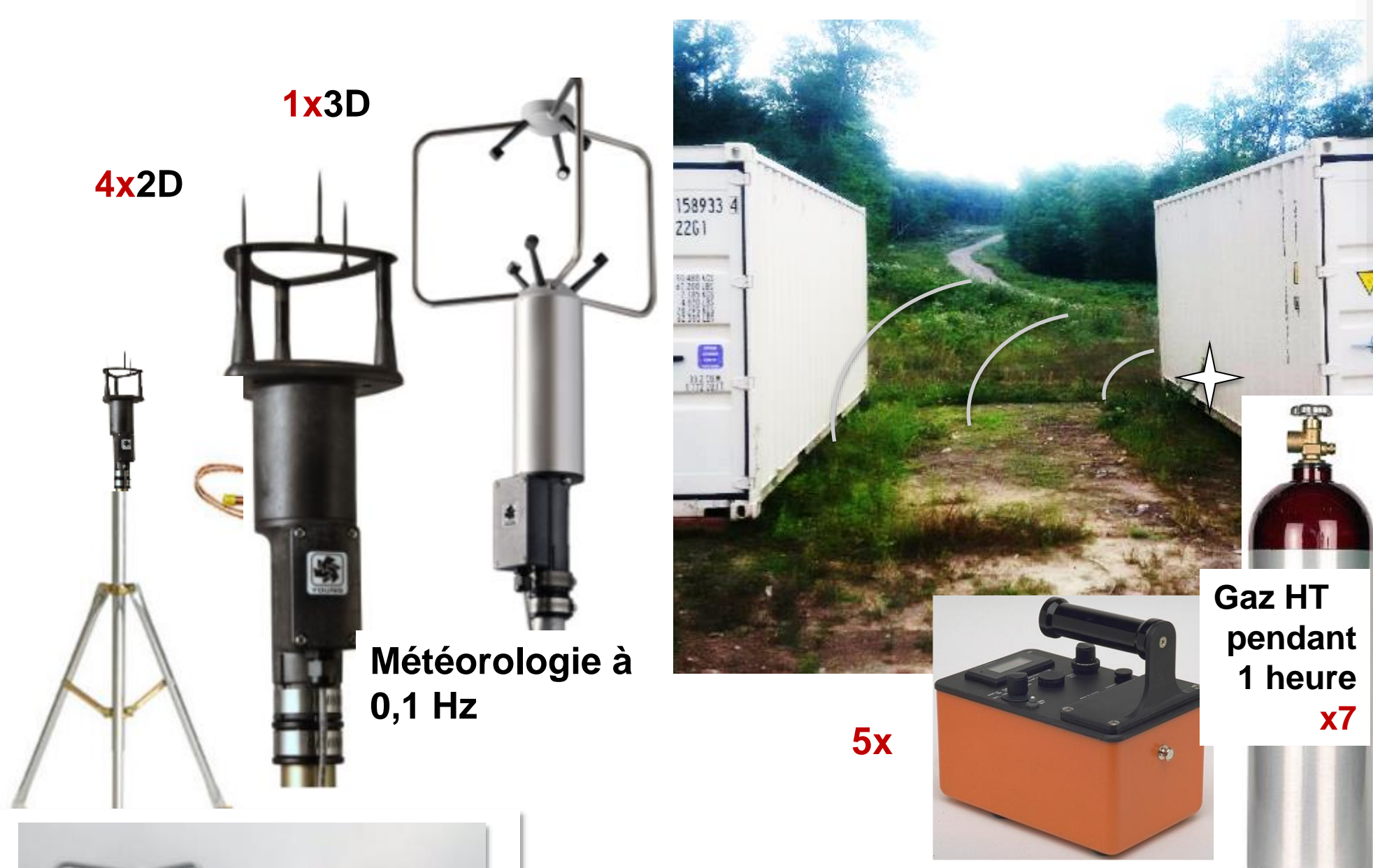
Figure : Installation d'expérience de traceur de tritium en 2018
